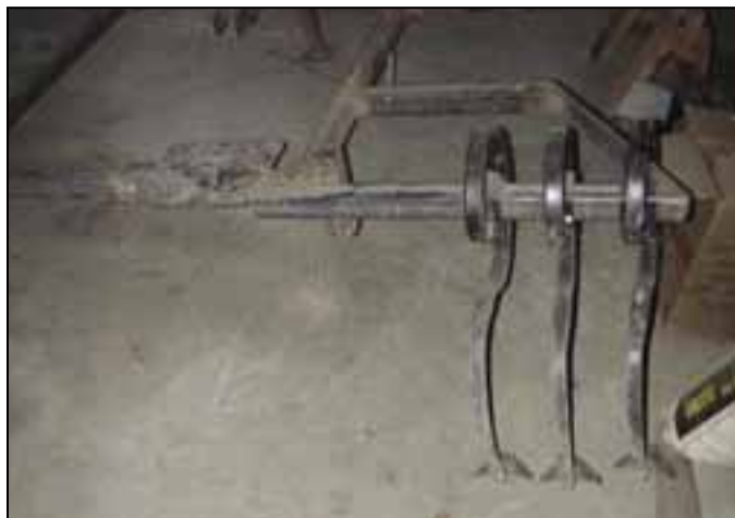
Figure 24 – Appareil à trois dents pour sarcler près des vignes.
