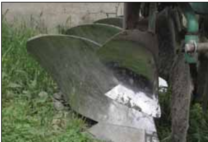
Figure 10 – La rasette sur une charrue permet de mieux enfouir les rhizomes et les tiges de chiendent au fond de la raie.
