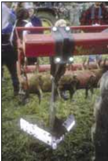
Figure 12 – La « herse » à chiendent de Walter Kress qui combine le déchaumage et le triage (photo : Denis La France).
